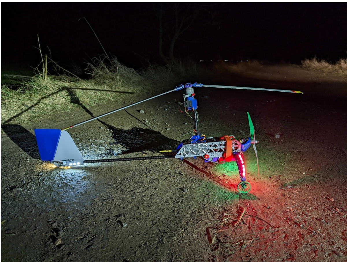
Obr. 1: Vírník TF-G2 s přístrojem pro měření prachových částic, fotografie z místa startu.
